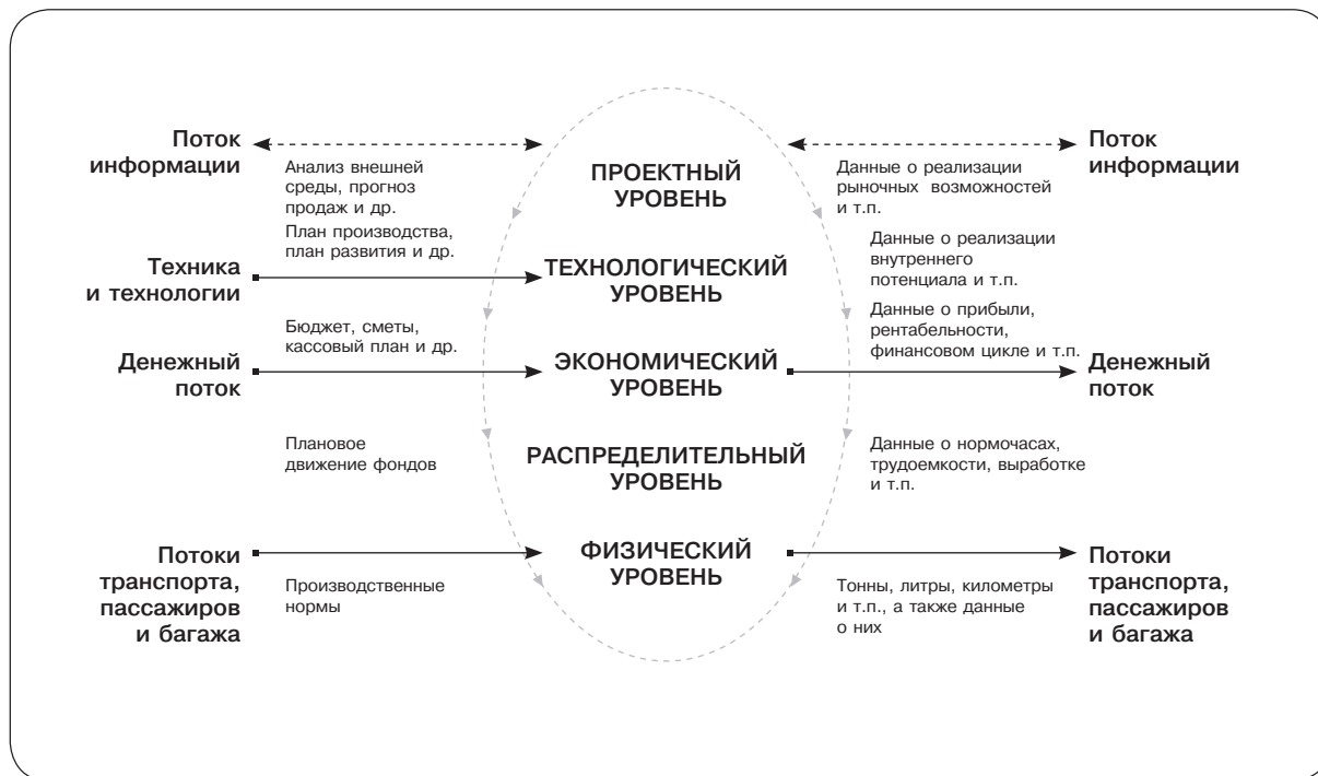
Рис. 5. Потоки информации, транспорта, пассажиров и багажа аэропорта
